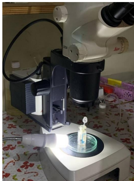
Figure 50 : Loupe binoculaire de marque « Leica » modèle « S8 AP0 ».
