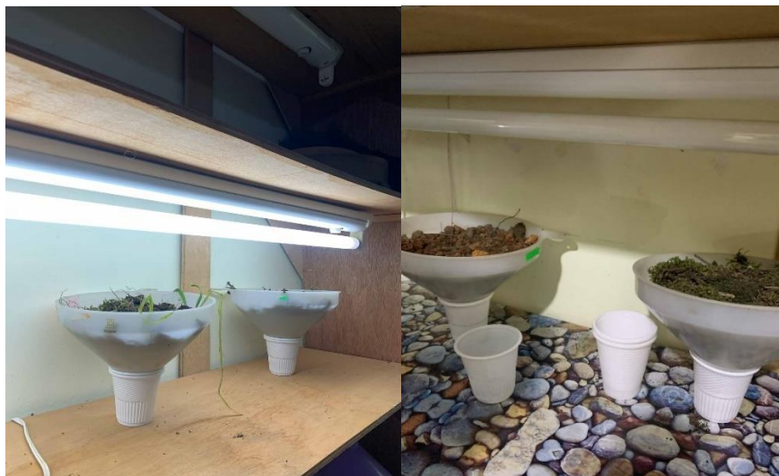
Figure 48 : Extraction des arthropodes par la méthode de Berlèse-Tullgren (Photo originale)
